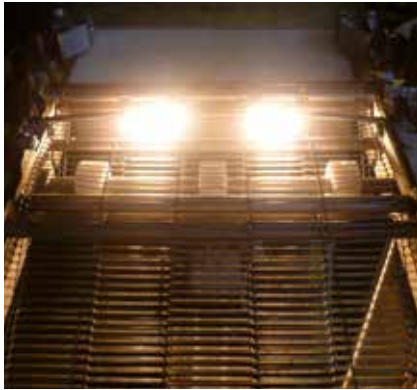
Ausgestattet mit Lampen gegen die Verfestigung für die in den Tank zurückfließende Schokolade.
